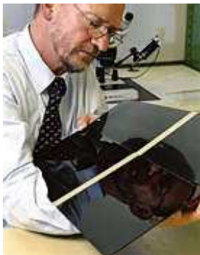
Nano-Klarlack im Test: Lackmuster werden von Experten begutachtet
